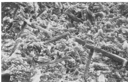
Abb. 31. Steigerung der Bruchzähigkeit K_{Ic} durch in-situ-Whiskerverstärkung [191]. Links: Gefüge eines konventionellen \text{Si}_3\text{N}_4 -Werkstoffes ( K_{Ic} = 6.5 \text{ MPa m}^{1/2} ); rechts: Gefüge eines in-situ-whiskerverstärkten Werkstoffes ( K_{Ic} = 9.5 \text{ MPa m}^{1/2} ).
